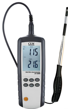
Fig. 3. ST-3880 hot wire ANOMET.
